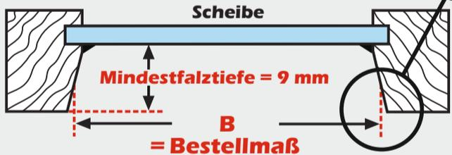
Bei einer schrägen Glasleiste messen Sie die Breite **B**
