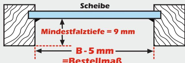
Bei einer geraden Glasleiste messen Sie die Breite **B**
